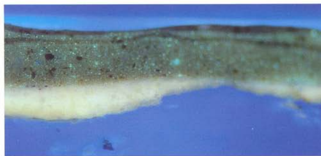
Сл. 112 КИЋЕЊЕ НЕВЕСТЕ, микрофотографија \times 200 , а) попречни пресек наранџасте боје (уочљиво 5 слојева) узорак са осликане десне ивице, б) УВ снимак са видљивом флуоросценцијом карактеристичном за цинк белу
